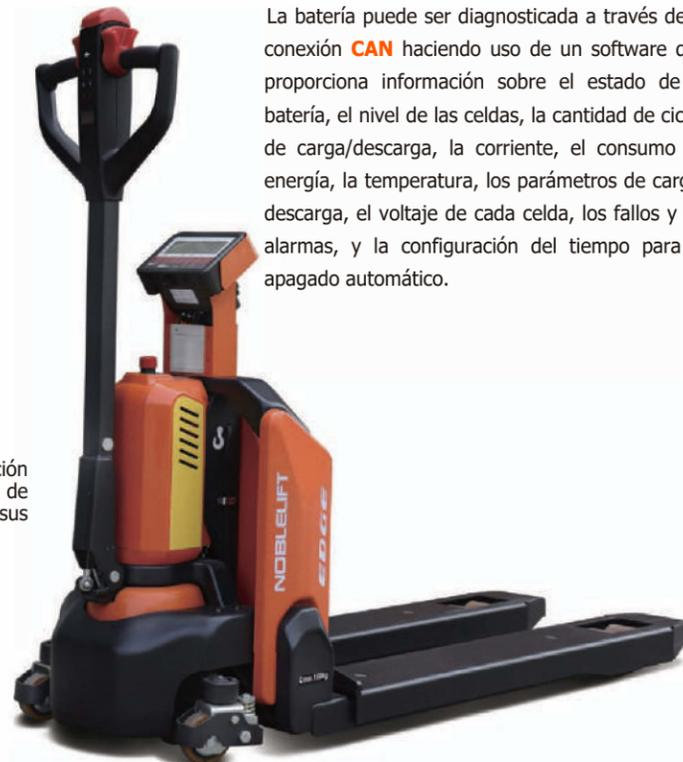
La batería puede ser diagnosticada a través de la conexión **CAN** haciendo uso de un software que proporciona información sobre el estado de la batería, el nivel de las celdas, la cantidad de ciclos de carga/descarga, la corriente, el consumo de energía, la temperatura, los parámetros de carga/descarga, el voltaje de cada celda, los fallos y las alarmas, y la configuración del tiempo para el apagado automático.
