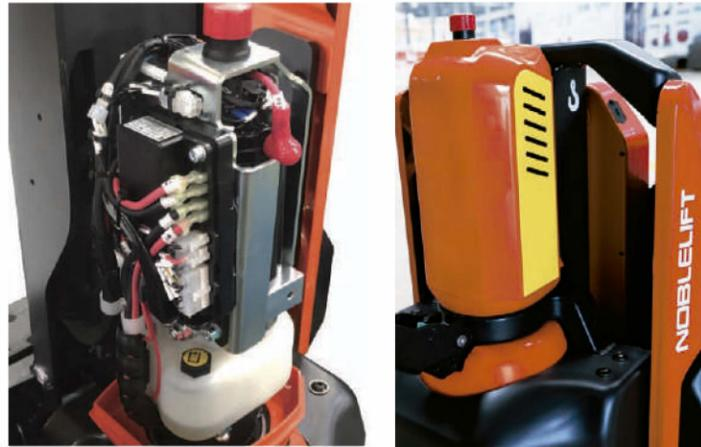
En las transpaletas no se utilizan mangueras ni tubos en el circuito de elevación hidráulica, lo que mejora significativamente la **fiabilidad** y reduce la cantidad de problemas potenciales relacionados con las fugas a través de los conectores o sus juntas.
