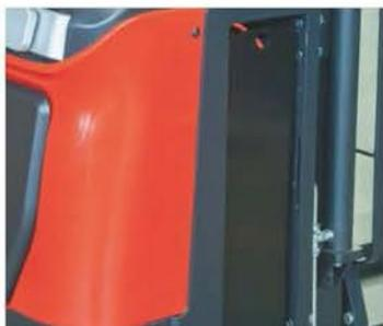
La opción de reemplazo de batería lateral permite a los clientes usar la transpaleta para varios turnos y así no perder tiempo en el complicado procedimiento de reemplazo de batería a través de la parte superior. Con la ayuda de un pequeño carrito las baterías se pueden reemplazar de forma rápida y sin esfuerzo.
