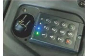
▶ La opción de acceso al panel median PIN-CODE, que funciona no solo con PIN-CODE sino también con tarjetas de acceso (RFID), que puede acceder a la limitación de la flota que puede ser utilizada por más de un operador. La opción de cargador incorporado puede ayudar a simplificar los procesos de carga para los clientes que usan las transpaletas no tan intensivamente (sin la operación de múltiples turnos conectada con la necesidad de reemplazar la batería).
