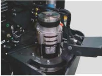
▶ Potente unidad de accionamiento AC de los líderes mundiales de la industria: El motor de tracción AC diseñado y producido por Schabmuller se combina con la transmisión de ZF de máxima calidad y está equipado con un freno electromagnético Intorq. La motor puede proporcionar una velocidad de desplazamiento de hasta 8km/h. El uso de ruedas motrices de calidad superior de los fabricantes alemanes Radel Vogel o Wicke ayuda a garantizar una larga vida útil de los neumáticos (PU)
