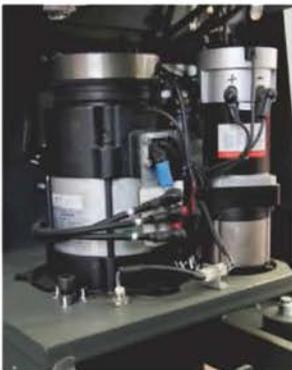
▶ La gama de modelos se puede equipar con la opción de Dirección Asistida Eléctrica (EPS) que ofrece un control preciso y rápido para la posición del volante y tiene un alto nivel de fiabilidad y seguridad de acuerdo con las normas oficiales.
