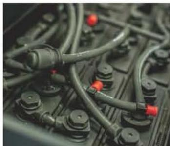
La transpaleta puede ser equipada con la opción de Aquamatic, un sistema de recarga rápida de agua destilada en las baterías de plomo-ácido. La transpaleta de 2 toneladas puede ser equipada con una batería 3VBS estándar, que ayuda a reducir la longitud de la carretilla original y la hace más compacta. (La batería estándar es de 2PZS)
