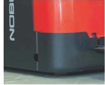
▶ El uso de una cubierta con un grosor de 8,, permite garantizar la resistencia del chasis y su resistencia incluso en caso de colisión contra objetos. La fuerte tapa de la batería hecha de aero ayuda a proporcionar un alto nivel de
