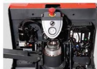
El diseño de las transpaletas y los componentes utilizados están diseñados para facilitar el trabajo y el mantenimiento. Todos los componentes son fáciles de alcanzar al retirar la cubierta principal solo con 2 tornillos, la rueda motriz y las ruedas estabilizadoras son fáciles de sustituir sin necesidad de elevar la transpaleta.
