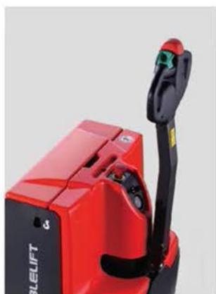
En particular, a través del diseño de timón largo, el operador siempre puede mantener una distancia segura a la carretilla durante el trabajo de forma muy ergonómica.
