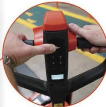
La función de conducción con el **timón vertical** permite desarrollar trabajos en sitios de espacio reducido, como ascensores y camiones sin comprometer la seguridad.
