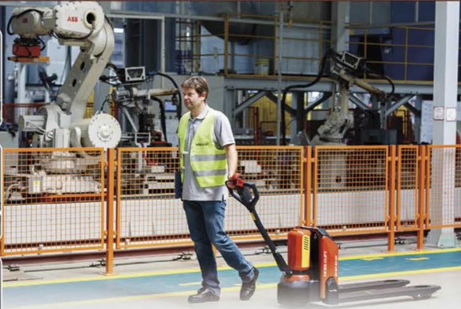
Con una capacidad de hasta **1.500 kgs** y posibilidad de superar rampas entre el **4/16%** de desnivel (cargada / descargada) hacen de la **EDGE** la transpaleta ideal para trabajos en muelles de carga y operaciones de entrega en diferentes condiciones.
