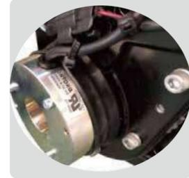
Motor sin escobillas de 48 V CC, bajo costo de energía, sin escobillas de carbón, sin chispas, funcionamiento suave, alta eficiencia, baja tasa de fallas, bajo costo de mantenimiento, bajo nivel de ruido, larga vida útil.
