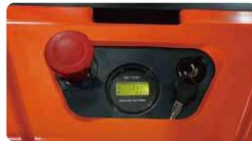
Dispositivo de protección de descarga profunda de la batería, indicador de descarga de voltaje con función de li\_ing y corte automático de bajo voltaje, para una mayor duración de la batería El interruptor de emergencia probado y el indicador de descarga de voltaje lo hacen más duradero y confiable. El indicador muestra fallas a través de CAN-BUS, no es necesario quitar las carcasas del indicador.
