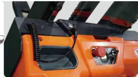
Todas las partes del apilador son fáciles de mantener, sin necesidad de herramientas especiales. Cargador incorporado de 8A. Batería de plomo-ácido sin mantenimiento, 48Vx60Ah. Potente sistema de bomba de 48v2.2kw y potente accionamiento.
